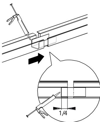
**4.** Die zweite Rinne an der anderen Seite der Rinnenverbindung über ein Viertel des verbindungsstücks schieben und den Anschlussrand mit Silicon abdichten.
