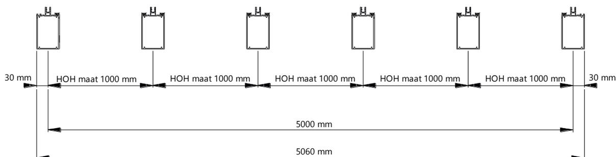
Bei der Montage von Platten mit Standardmaßen muss somit auch bei einer verbundenen Überdachung die Gesamtbreite (X) letzten Endes  $X + 60$  mm betragen, d.h.: 8060 mm, 9060 mm, 10060 mm etc.
