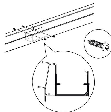
**6.** Jetzt kann die Rinnenverbindung mit den kurzen Edelstahlsschrauben im Rinnenraum und auf der Vorderseite unter der Zierleiste befestigt werden. Zum Schluss das Ganze mit Silicon glatt und wasserdicht versiegeln!
