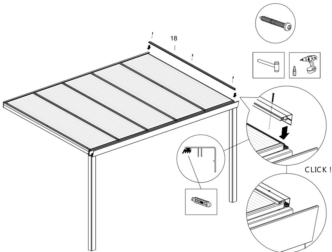
6. Jetzt als zusätzliche Sicherung an der Rinne auf jedem Zwischenträger einen Plattenstopper schrauben.
