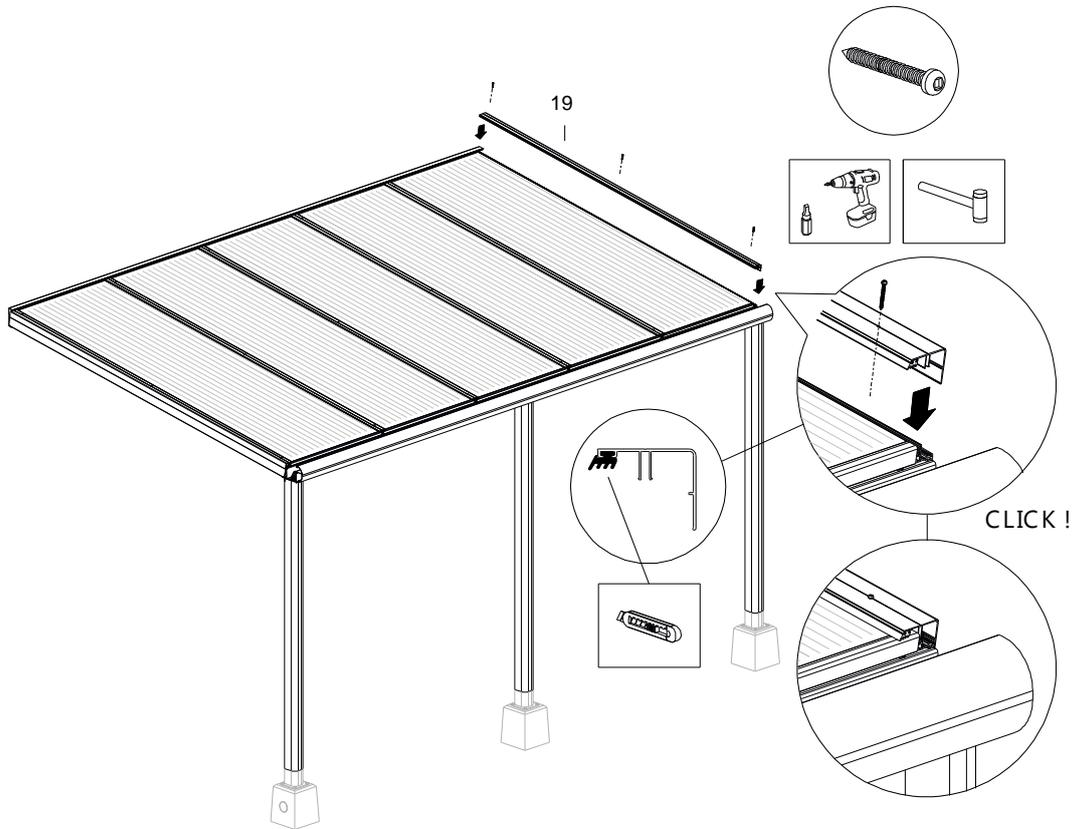
12. Jetzt als zusätzliche Sicherung an der Rinne auf jedem Zwischenträger einen Plattenstopper schrauben. **Achtung:** Die Sicherung der Seitenleisten erfolgt später.
