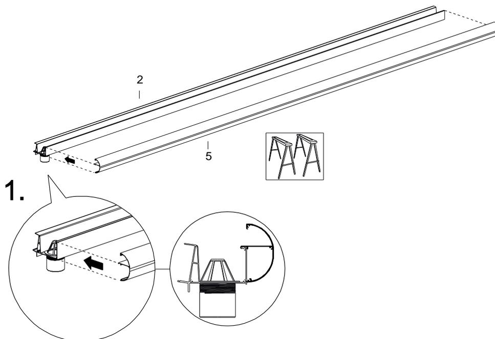
2. Die Zierleiste mit den zum Lieferumfang gehörenden kurzen Edelstahlsschrauben 19 mm befestigen. Ca. 5 cm von der Seite entfernt beginnen und ca. alle 50 cm eine Schraube anbringen. Die letzte Schraube wird ca. 5 cm von der Seite entfernt angebracht.
